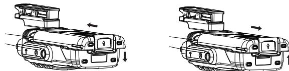
Для того чтобы снять АКБ, необходимо сначала выключить радиостанцию. Затем следует нажать на фиксирующую защелку и вытянуть АКБ в направлении, указанном на рисунке стрелками. Когда АКБ будет выступать за пределы корпуса радиостанции на 1-2 см, её можно будет отсоединить.
